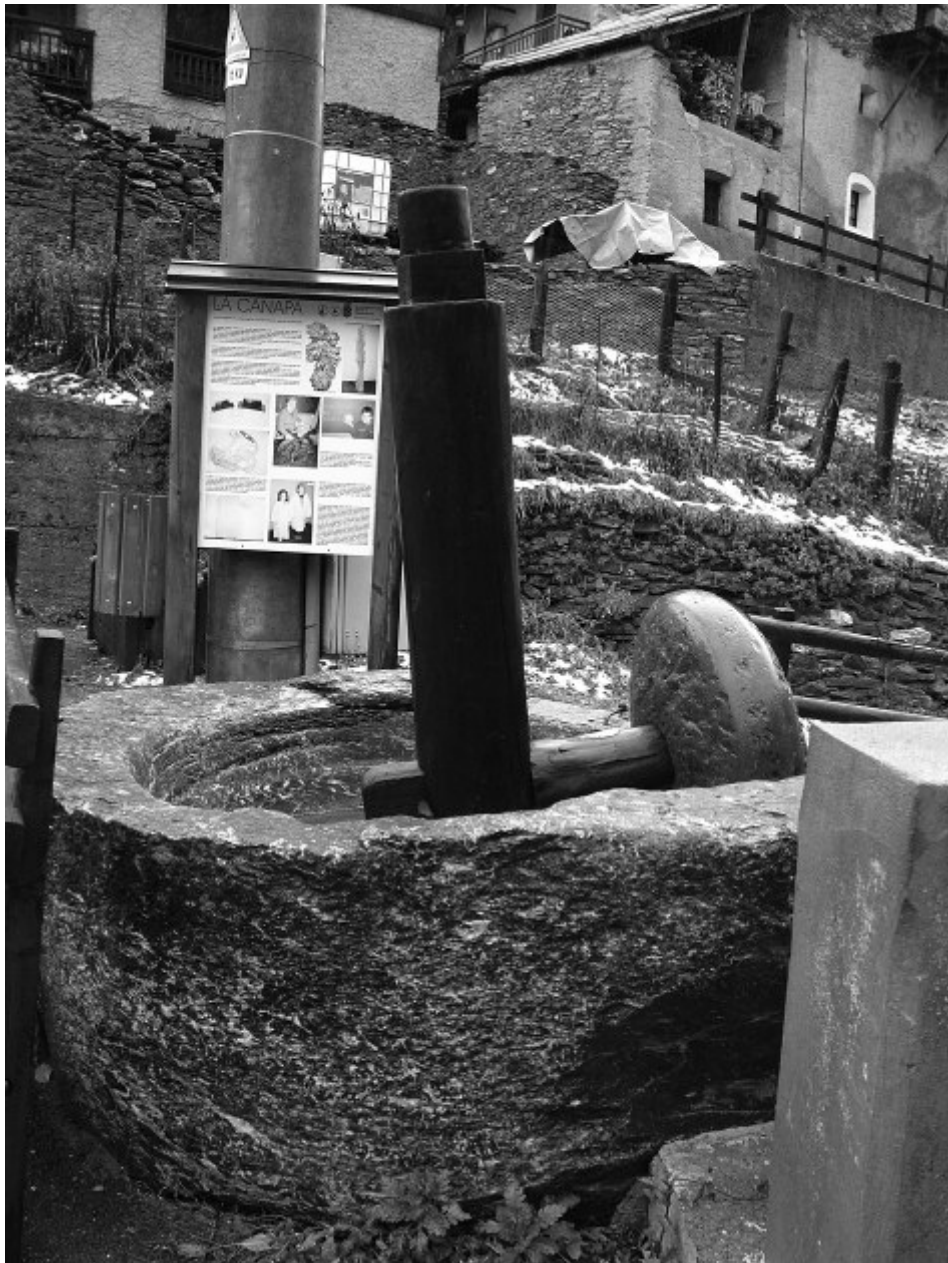
Fig. 19) Pesta da canapa esposta vicino al ponte di Rochemolles. Vi è anche un pannello esplicativo sul processo di lavorazione della fibra vegetale.
