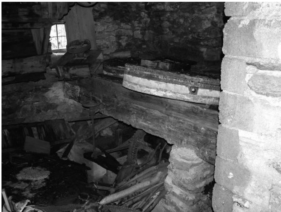
Fig. 30) Vista dell'interno del Mulino Mediano. Si notino i due palmenti e, sulla destra, la muratura del pozzo della turbina elettrica.
